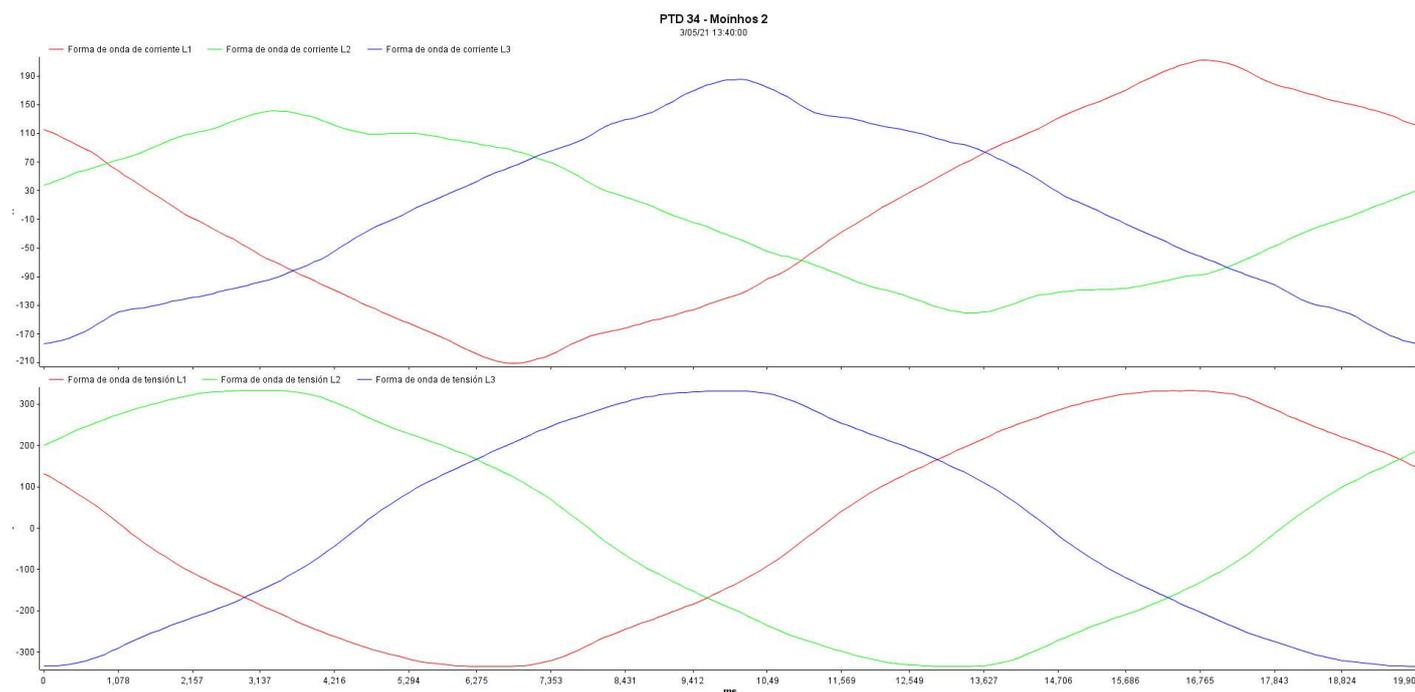
Como se pode ver a onda de tensão aproxima-se muito da sua forma sinusoidal apresentando uma THD nunca superior a 5,0%, portanto bem inferior ao valor máximo fixado pela norma NP EN 50160 (8,0%).
