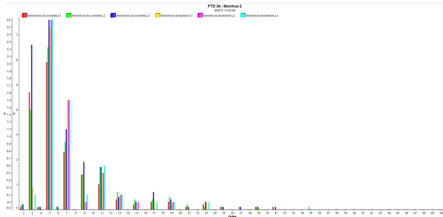
Já que respeitante á onda de corrente e também como é perfeitamente visível nos gráficos anteriores a distorção da onda de corrente é muito relevante como resultados do aparecimento crescente de cargas não lineares (iluminação LED, variadores de velocidade, climatização, equipamento de informática e em geral todo o equipamento com conversão da corrente alternada em corrente contínua).
